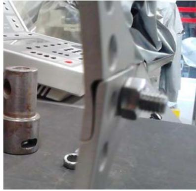
Fig. 9. Deformación de la unión atornillada del aro a carga máxima.
