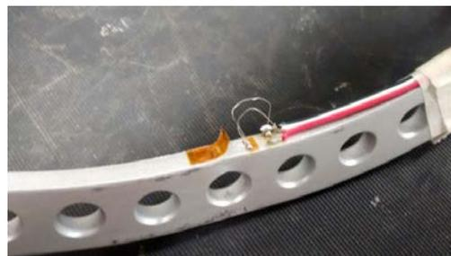
Fig. 21. Desprendimiento del strain-gage por grandes deformaciones.
