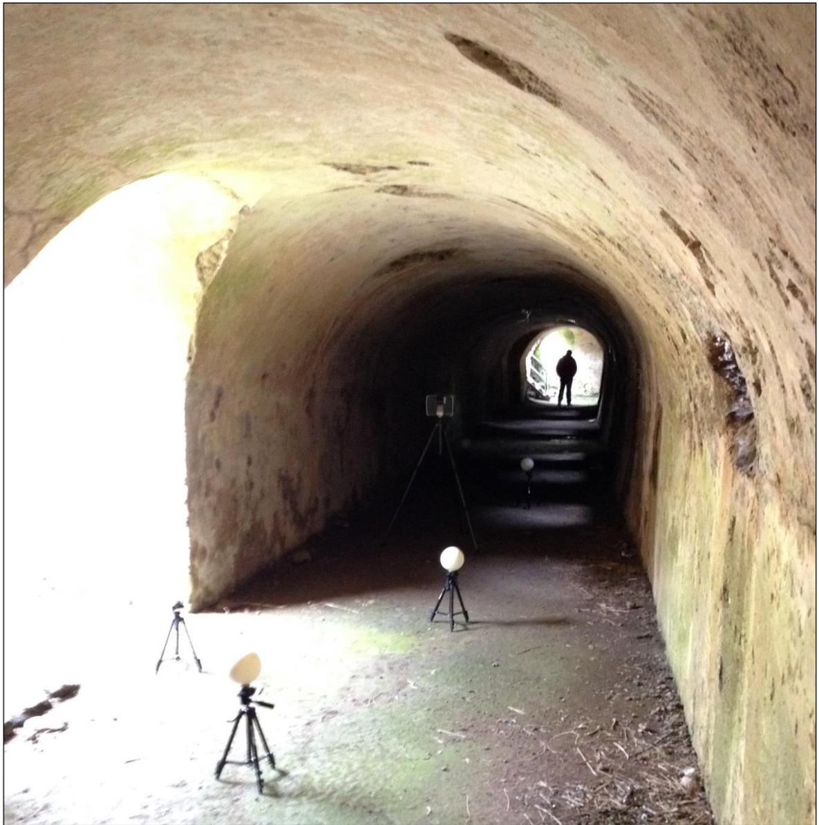
*Figura 4.44. Veduta interna del criptoportico con il posizionamento dei target e del laser scanner.*
