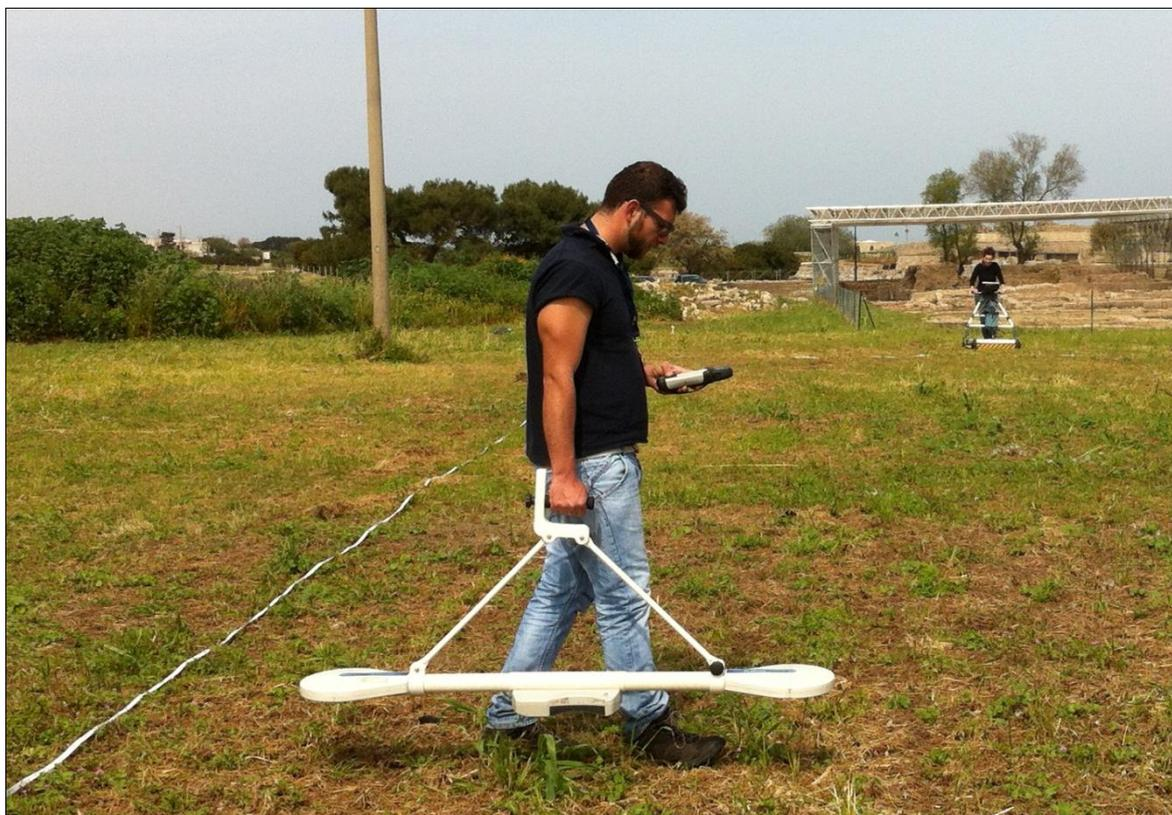
*Figura 4.9. Acquisizione dei dati mediante Profiler EMP-400.*
