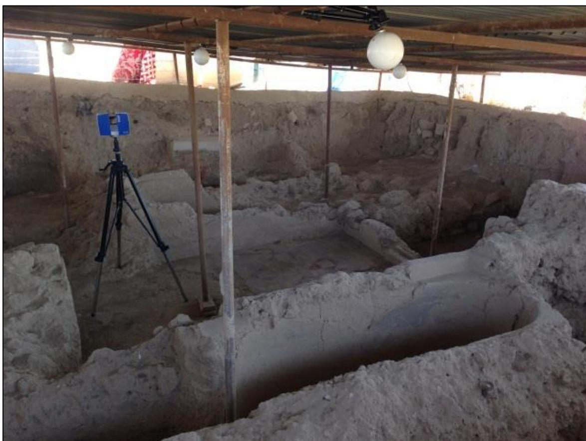
*Figura 5.65. Sinistra acquisizione delle scansioni tramite laser scanner, destra acquisizione delle immagini per la produzione di ortofoto.*
