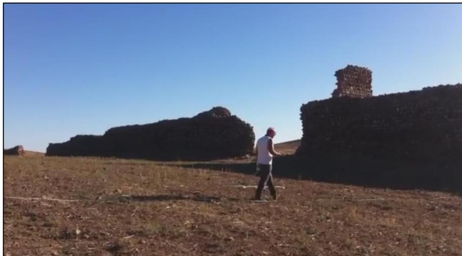
*Figura 5.34. Acquisizione dei dati con Profiler EMP-400 (GSSI)*
