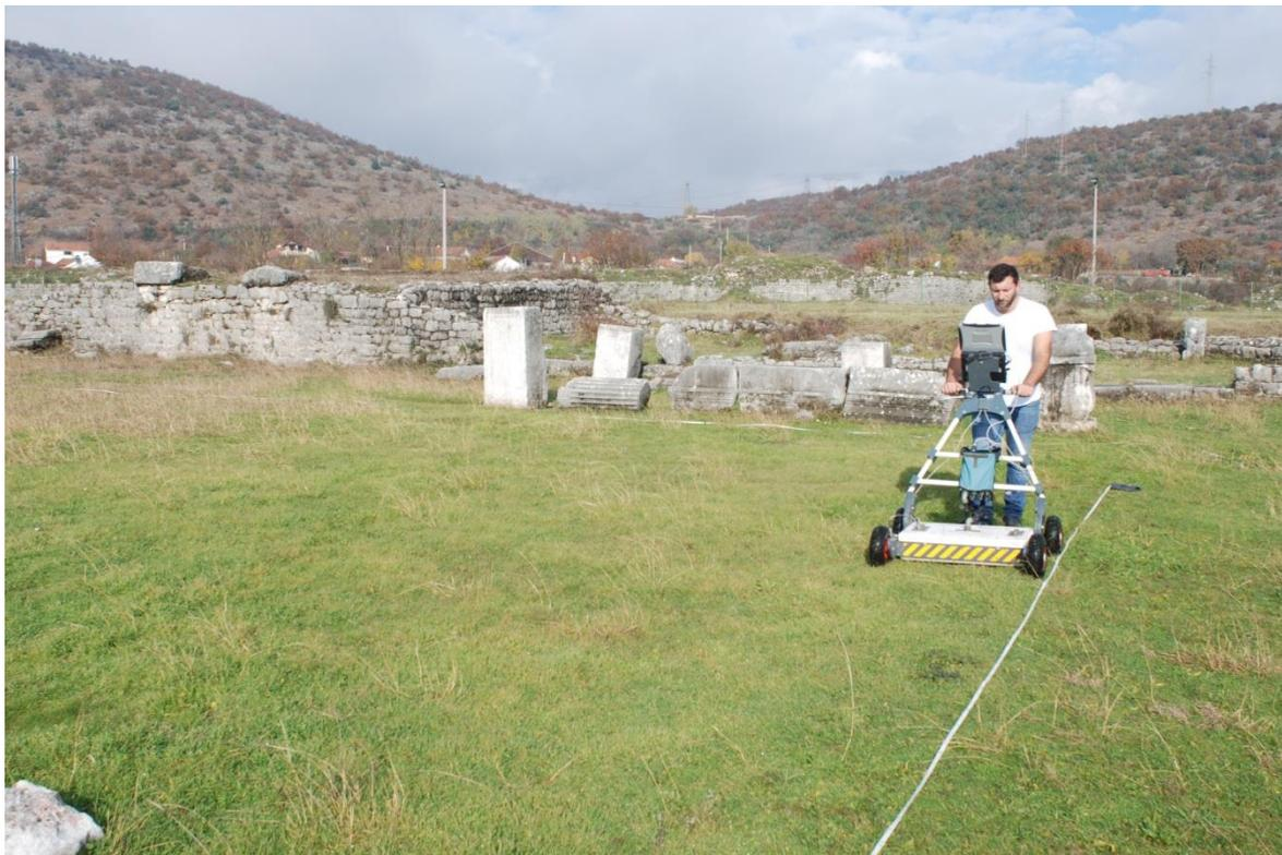
*Figura 5.5. Acquisizione dati con georadar IDS*
