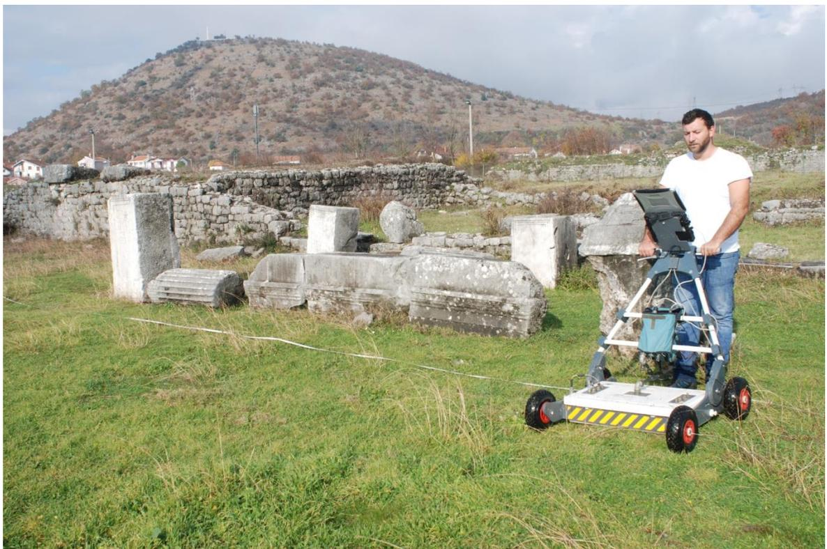
*Figura 2.11. Sistema GPR utilizzato per l'acquisizione dei dati.*
