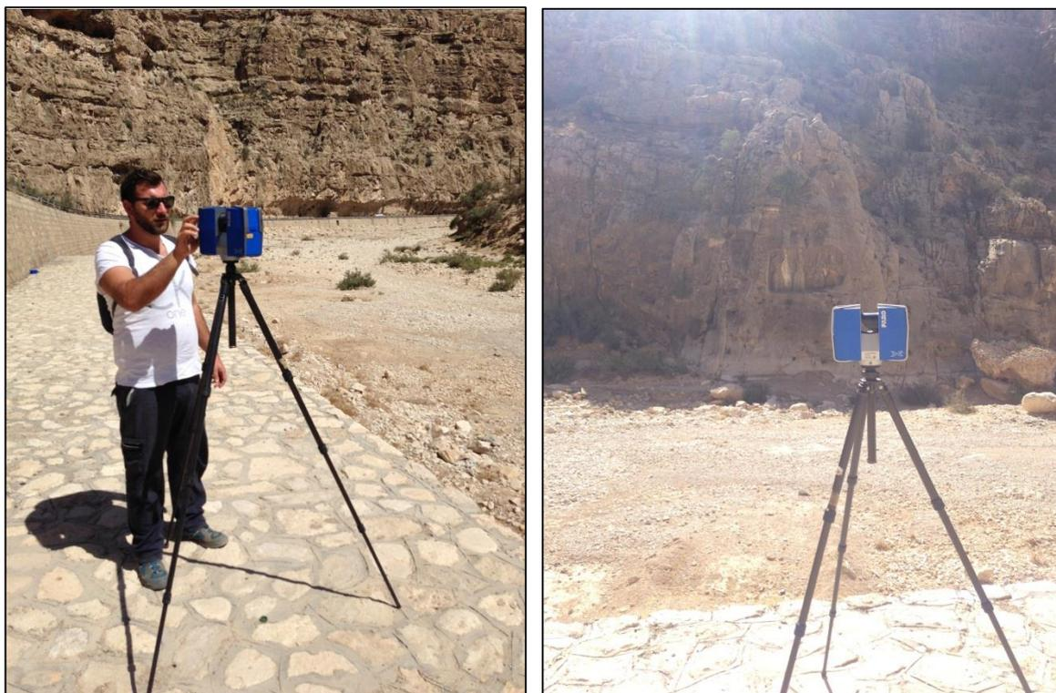
*Figura 5.76. Impostazione della risoluzione (sinistra), acquisizione della scansione (destra).*
