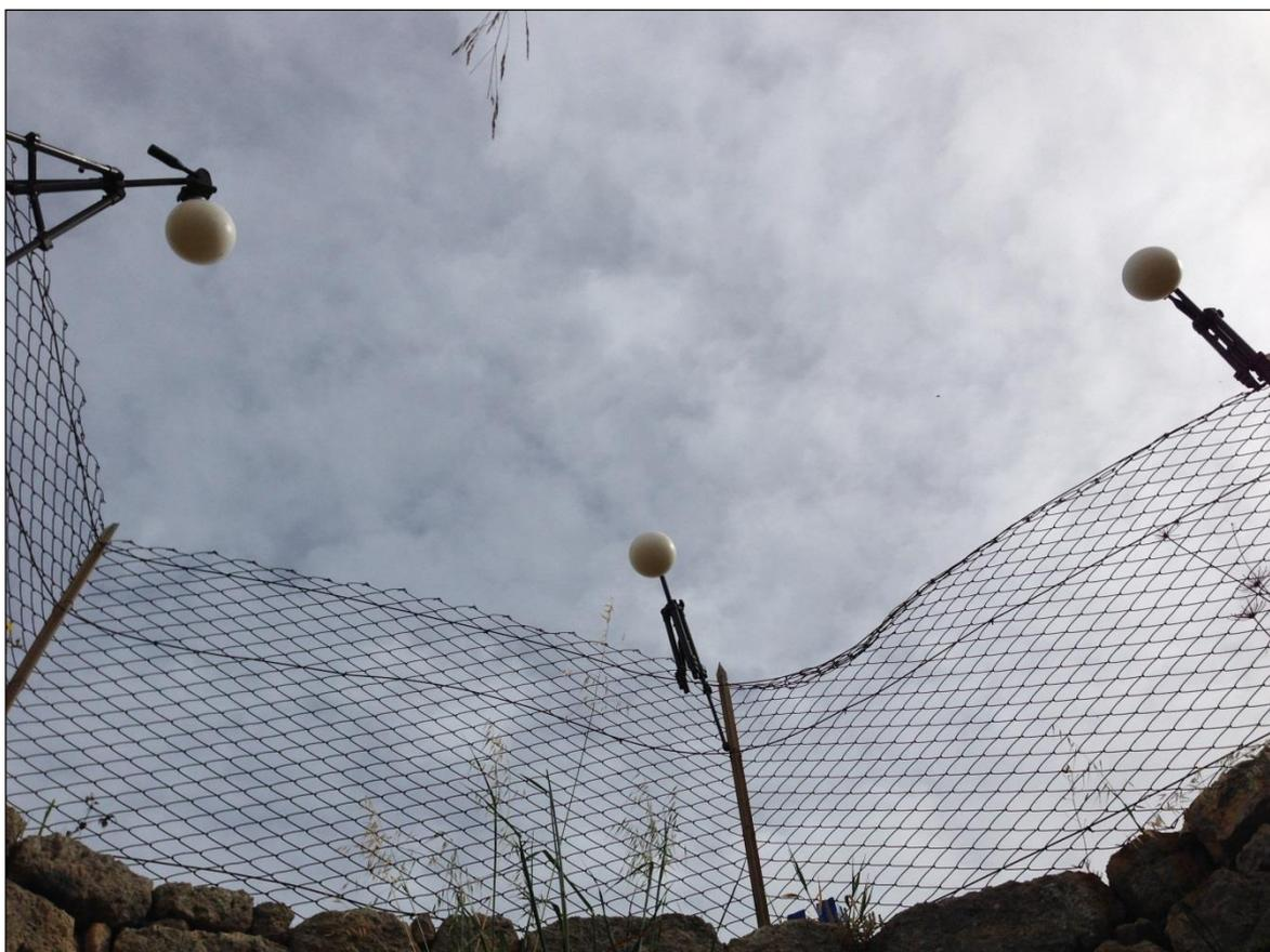
*Figura 4.43. Target sferici utilizzati per agganciare la parte superiore con l'ipogeo.*
