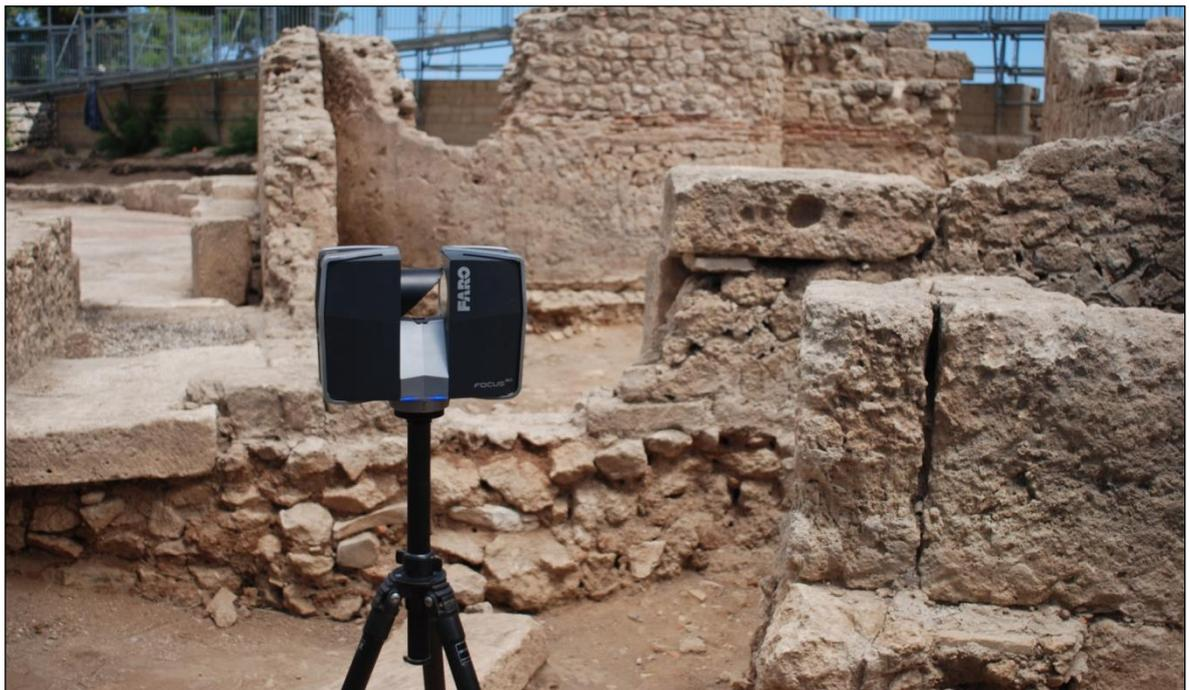
*Figura 3.6. Laser scanner Focus 3D MS120 della FARO.*
