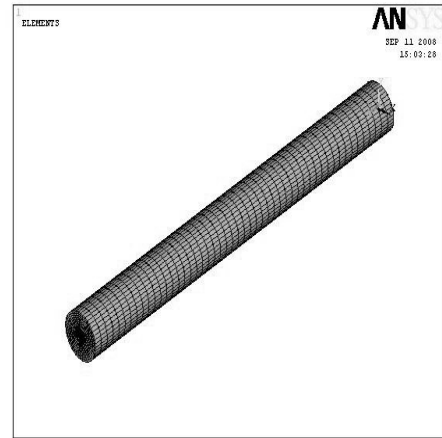
Fig. 2. FEM of wire
