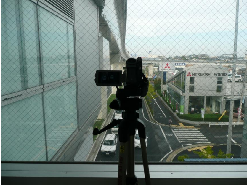
図 4.1：観測状況（駅構内の渡り廊下より，ビデオカメラで公道を撮影）
