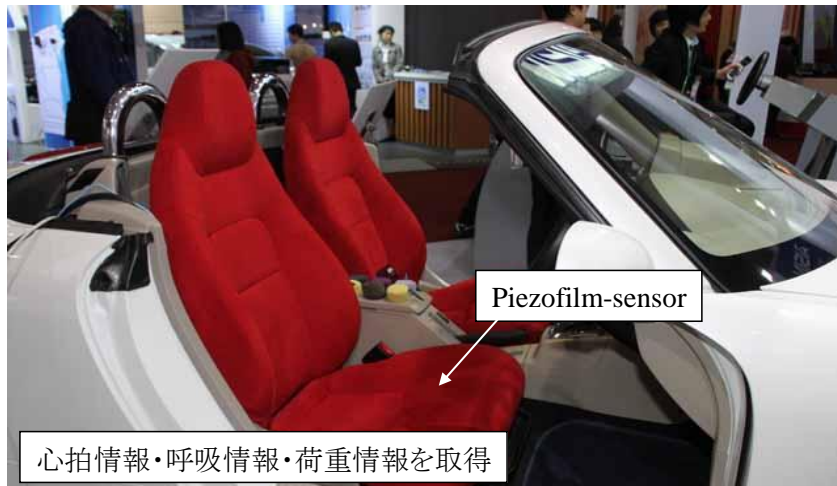
図 3.3 : 心拍情報・呼吸情報・荷重情報取得可能なシート型センサ (引用 : ITSWC2010 アイシン精機ブース)
