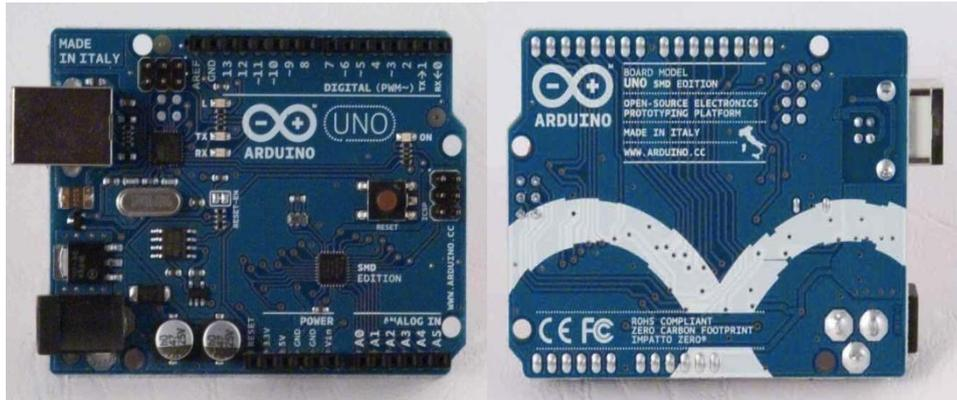
Gambar 2.1 Arduino Uno R3 Sisi Depan (Kiri) dan Belakang(Kanan)
