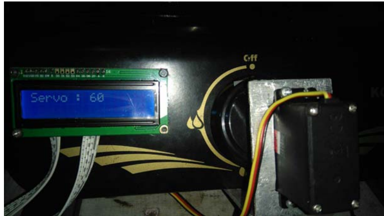
Gambar 4. 7 Pengujian Motor Servo Pada 60 Derajat
