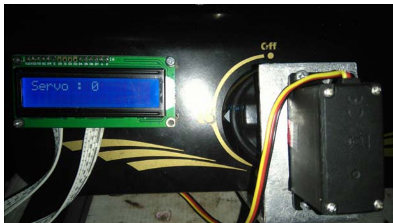
Gambar 4. 6 Pengujian Motor Servo Pada 0 Derajat
