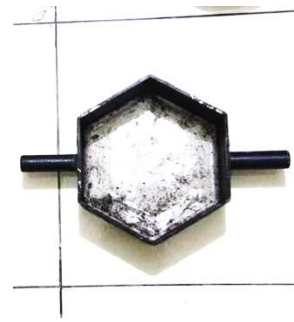
Gambar 3. produk segmen skloof balok moduler setelah 2 x 24 jam perawatan
