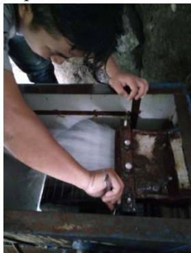
Gambar 6 Kegiatan pengukuran lebar bukaan katup terhadap putaran turbin
