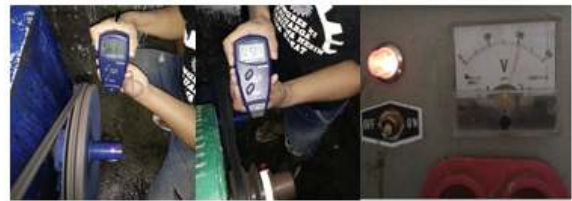
Gambar 7 Kegiatan pengukuran putaran turbin, putaran dan tegangan generator
