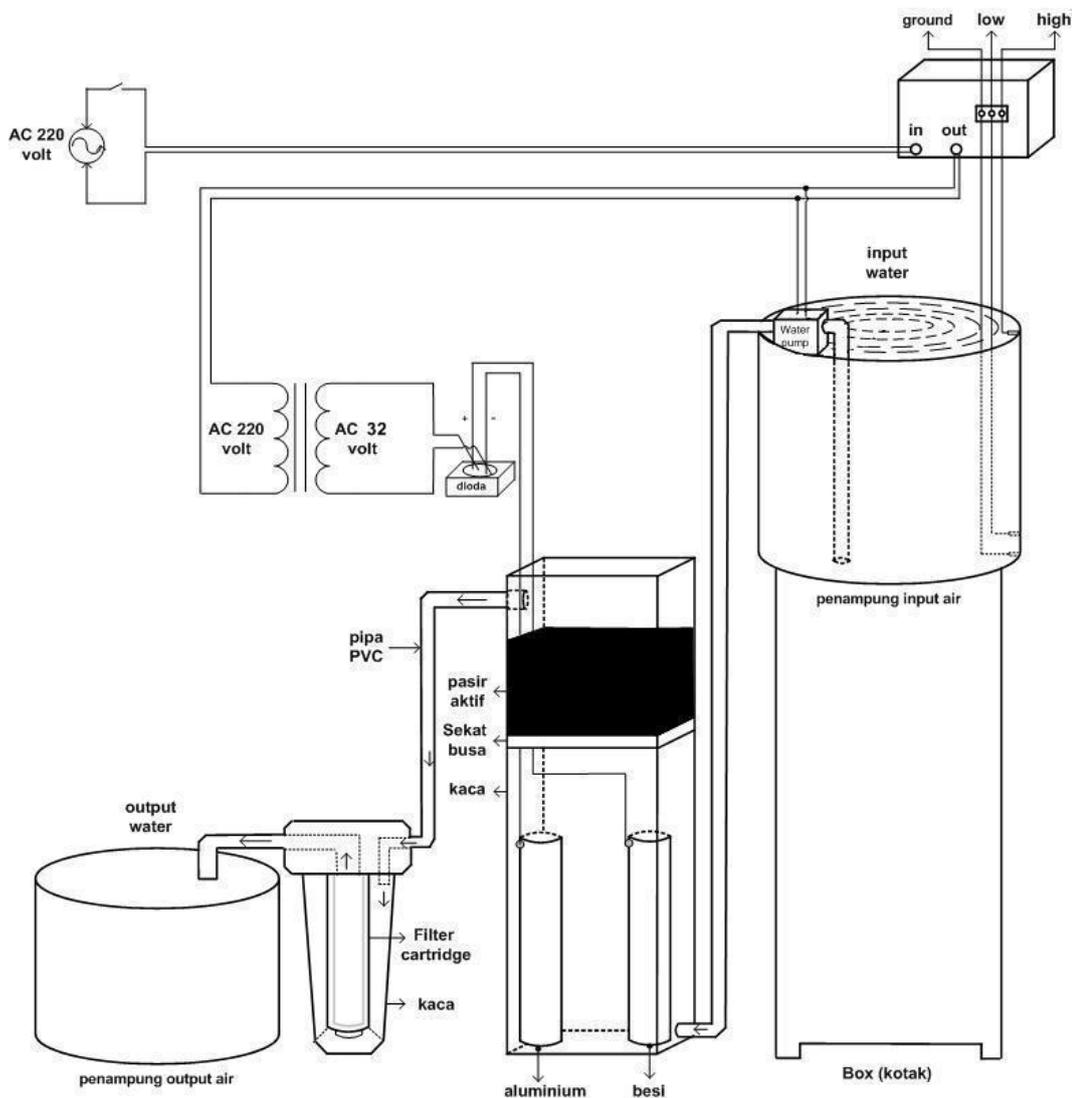
Gambar 2. Desain filter air dengan metode elektrolisa
