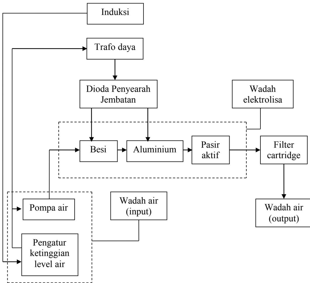
Gambar 3. Blok diagram filter air dengan metode elektrolisa
