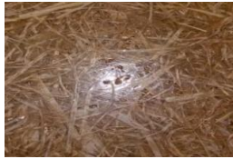
Gambar 9. Cacat pada permukaan spesimen vacuum bag
