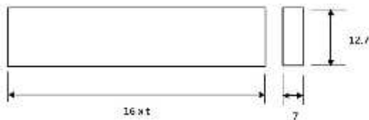
Gambar 3. Dimensi spesimen uji bending ASTM D790.
