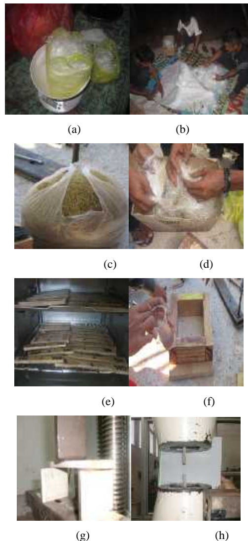
Gambar 8. Proses Penelitian. a). Memilah serat glass, b). Menimbang serat glass, c). Serat daun gwang, d). Mencampur serat daun gwang dan serat glass, e). Menyiapkan resin, f). Pengovenan spesimen, g). Uji tarik, h). Uji bending
