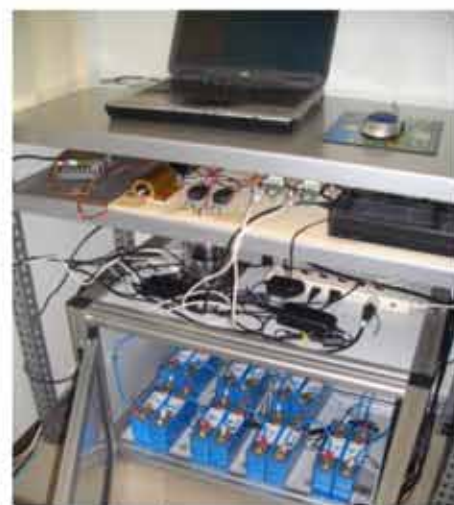
図5 蓄電池収納容器
