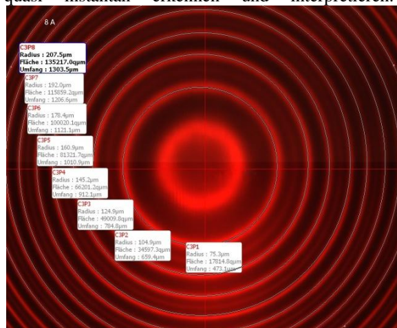
Abb.8: Vermessung der Interferenzringe. Anliegender Spulenstrom 8 A, Polarisationsfilter auf 0^\circ Stellung.
