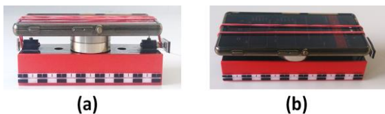
Abbildung 4: Aufbau des Wagens für das Smartphone-Experiment auf der Luftkissenfahrbahn aus zwei Perspektiven, (a) Bild von vorne, (b) Bild von schräg oben. Durch eine glatte Erhöhung wird das Smartphone vor Kratzern durch den Wagen geschützt. Die Befestigung des Smartphones erfolgt durch ein Gummiband, welches an den Fadenhaltern des Wagens befestigt wird.
