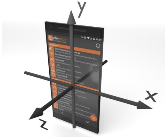
Abbildung 2: Koordinatensystem eines Smartphones. In diesem Koordinatensystem werden die Daten der Sensoren für die drei Raumrichtungen ausgegeben.
