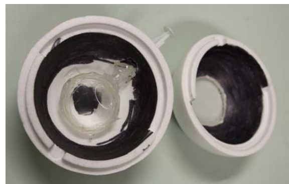
Abb. 19: Halb geöffnetes Augenmodell. Die akkommodationsfähige Augenlinse ist mit Wasser gefüllt.
