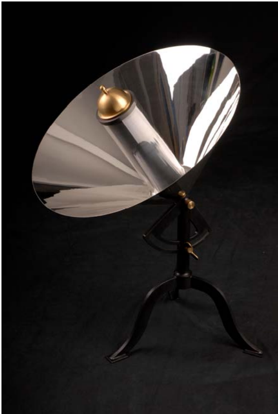
Abb.2: Nachbau eines Solarkochers von Mouchot
