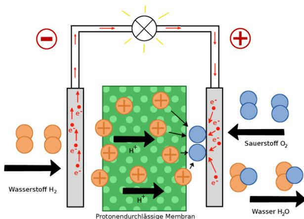
Abb.6: Schematischer Ablauf der Reaktion von Wasserstoff mit Sauerstoff in der Brennstoffzelle
