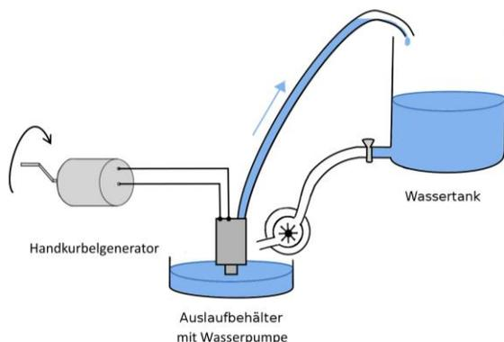
**Abb.5:** Schematische Darstellung des Wasserkraftmodells
