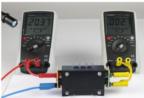
Abb. 17: Der Einfluss des Umgebungslichts wird mit Hilfe einer Taschenlampe untersucht.
