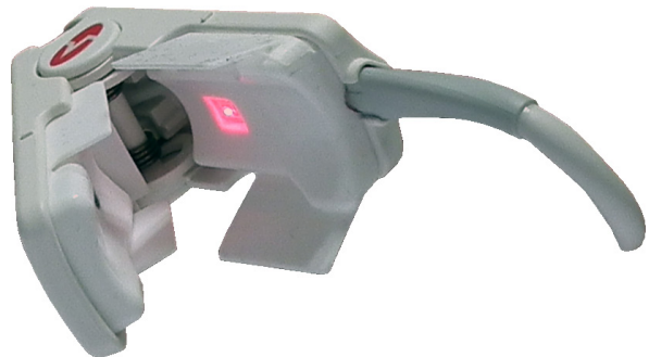
Abb. 8: Rote LED auf einer Innenseite der Messapparatur.
