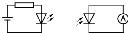
Abb. 10: Sender- und Empfängerschaltungen; Sender: z. B. mit LED TLHB850 (Vishay Semiconductors), blau, I_F = 20\text{mA} , U_F = 3,9\text{V} oder TLHK5800 (Vishay Semiconductors), rot, I_F = 20\text{mA} , U_F = 1,9\text{V} , Empfänger: z. B. mit Fotodiode SFH203 (Osram)
