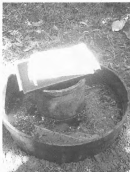
FIGURA 1- 2. Cilindros utilizados para determinar la velocidad de infiltración del suelo.
