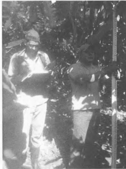
FIGURA 2- 1. Medición de altura total y diámetro a la altura del pecho
