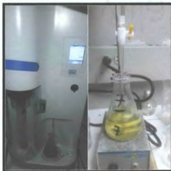
Figura 25. Proceso de destilado y titulación para determinar nitrógeno total, Laboratorio de Suelos y Agua IDIAP (2017).
