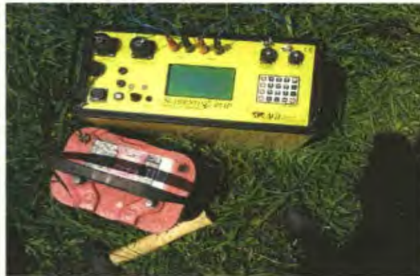
Figura 4.1. Medidor de resistividades SuperSting R1 IP de la AGI (Advanced Geosciences, Inc.)
