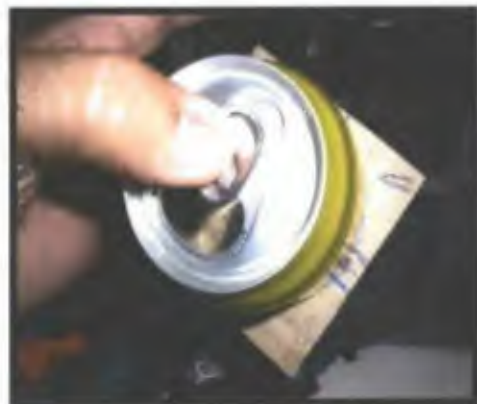
Foto propia 13. Corte de la lata paso 4 Se utiliza un molde de cartón para hacer los cortes en el lugar apropiado.
