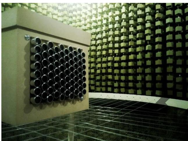
Fig. 5: PAL situado en la cámara anecoica del LAL-CIC
