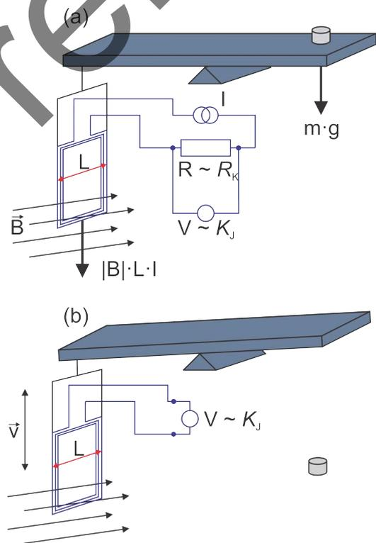
Fig. 11. Descripción gráfica del experimento de la balanza de Kibble. (a) Etapa estática. (b) Etapa dinámica.
