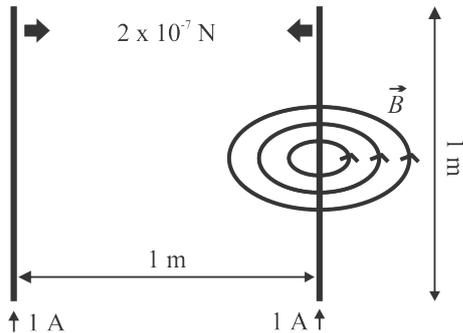
Fig. 3. Esquema del experimento teórico aprobado en 1948 para definir la unidad ampere.  $\vec{B}$  es el campo magnético generado por el cable.
