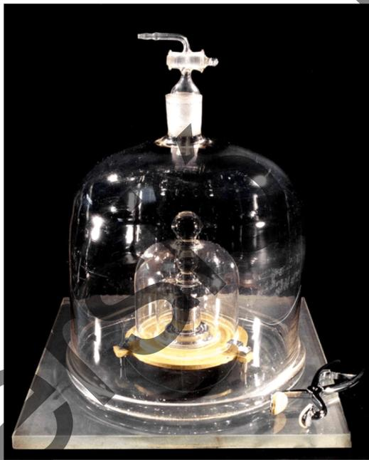
Fig. 1. Prototipo internacional del kilogramo que se conserva desde el año 1889 en el *Bureau International des Poids et Mesures* - BIPM. Es un cilindro con diámetro y altura de aproximadamente 39 mm, y de una aleación de 90% platino y 10% iridio. Foto cortesía del BIPM.
