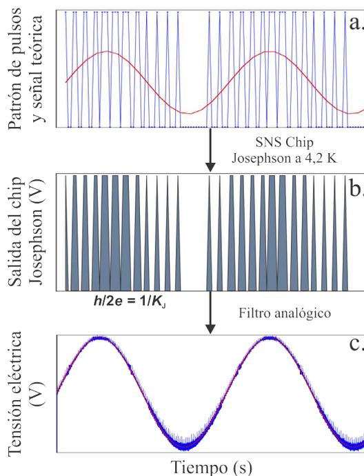
Fig. 16. (a) La señal deseada es codificada en un tren de pulsos, los mejores resultados se obtienen mediante modulación sigma-delta. Estos pulsos son generados en corriente e inyectados al chip Josephson. (b) Gracias al efecto Josephson, el área de los pulsos en tensión está cuantizada. (c) La tensión filtrada reconstruye la señal deseada con exactitud cuántica y gran pureza espectral.
