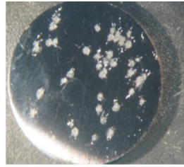
Fig. 5 - Curve potenziodinamiche e aspetto del provino di magnesio rivestito con DLC dopo la prova
