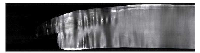
*Fig. 2 - Example of the tail of a strip that has been pinched in the finishing mill. Fig. 2 - Esempio di una coda di un nastro pizzicato nel treno finitore.*
