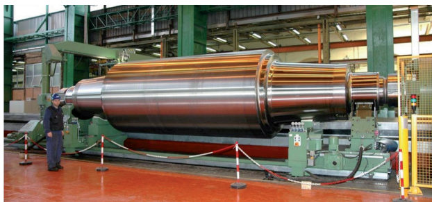
Fig. 1 - Cilindro di appoggio alla laminazione, diametro circa 2000 mm
