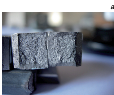
Fig. 11 - a) Frattura Campione 3 Kv 28J; b) Frattura Campione 12 Kv 31J
