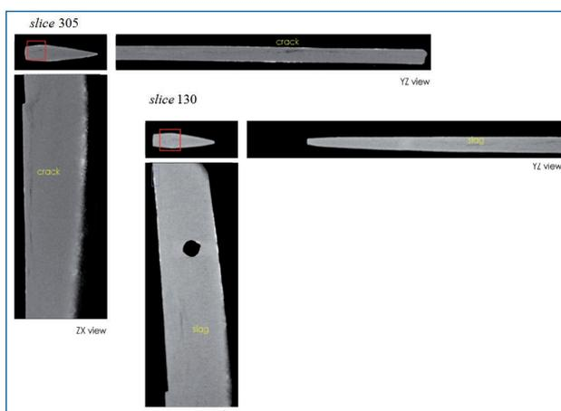
**Fig. 4 - In alto sono riportate due proiezioni, con relative viste ortogonali, ottenute dalla tomografia neutronica e realizzate sul campione S0: un crack è ben visibile lungo lo lori (slice 305), mentre alcune inclusioni di scorie sono state localizzate nel codolo (slice 130).**
