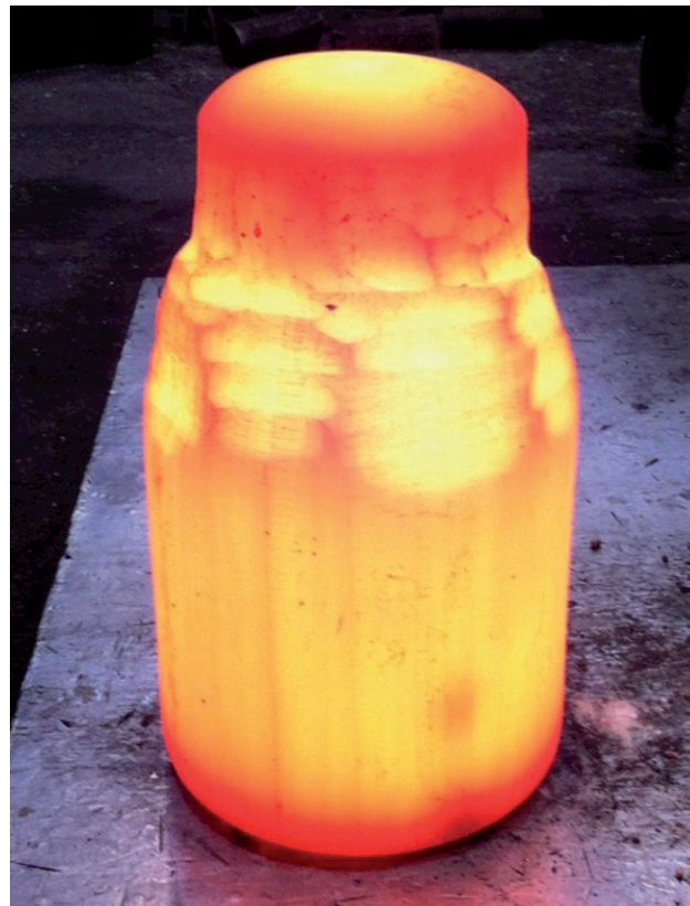
Fig.5 - Foto del pezzo dopo stiratura, alla fine della prima calda.
