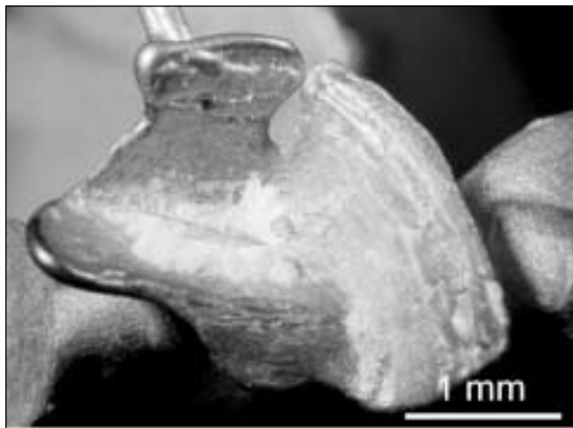
Fig. 14 – Incomplete device due to a too low casting temperature. Fig. 14 – Manufatto incompleto a causa della temperatura di colata insufficiente.
