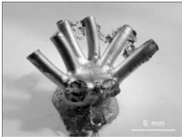
Fig. 15 – Typical fins on a portion of the former sprue, due to the investment breaking during pre-heating of the dental casting mold. Fig. 15 – Caratteristiche pinne su parte della spinatura, causate dalla rottura del rivestimento durante le fasi di preriscaldamento del cilindro.
