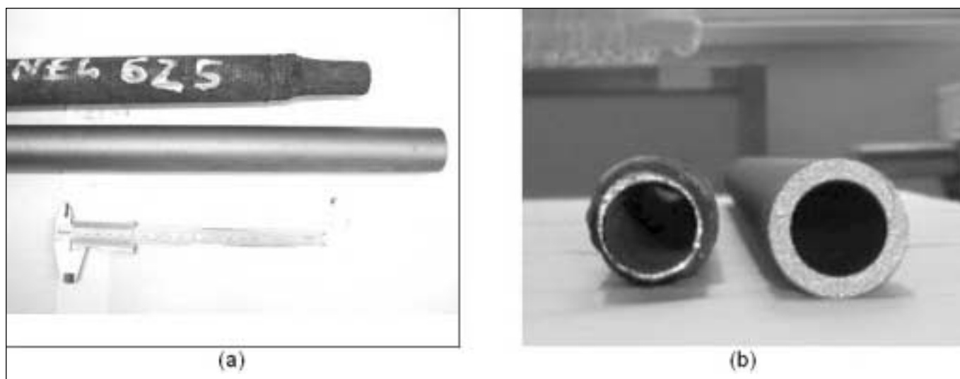
Fig. 5 – Confronto tra un tubo SH nuovo e un tubo parzialmente rivestito con IN625 mediante laser e dopo 6 mesi di esercizio: (a) sopra tubo parzialmente rivestito con estremità nuda a destra, sotto tubo nuovo; (b) a sinistra sezione corrosa del tubo dopo l'esercizio (spessore 1.3-1.6 mm) e a destra sezione del tubo nuovo (spessore 4.8 mm)
