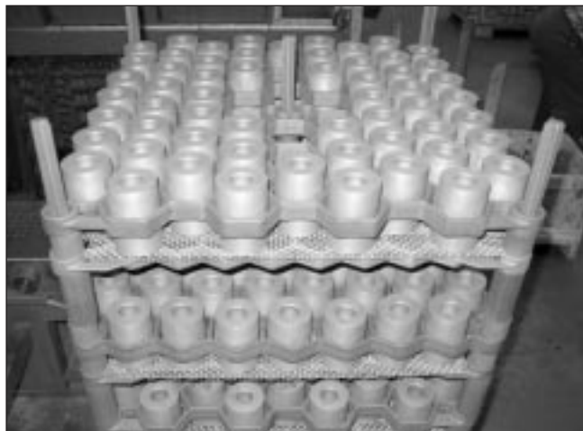
Fig. 10 - Load of 144 piston pins case-hardened to 1.0 to 1.5 mm. Fig. 10 - Lotto di 144 teste di pistoni cementati e temprati da 1,0 a 1,5 mm.
