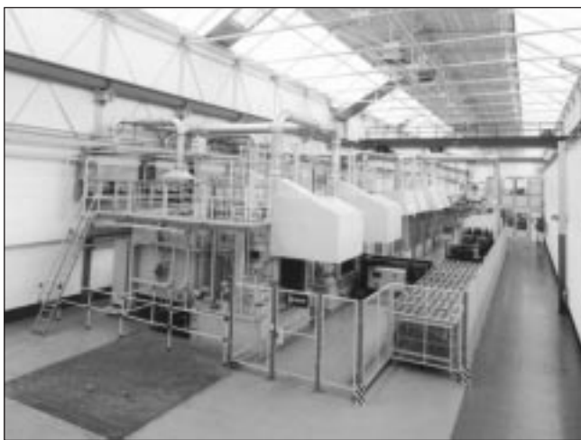
Fig. 7 – Tipica linea di forno a carica automatica con forni di tempra sigillati, di rinvenimento, caricatori/scaricatori e sequenziatori.
