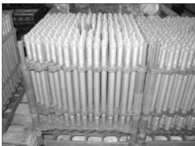
Fig. 11 - Load of 221 shafts case-hardened to 0.8 to 1.1 mm. Fig. 11 - Lotti di 221 alberi cementati da 0,8 a 1,1 mm.
