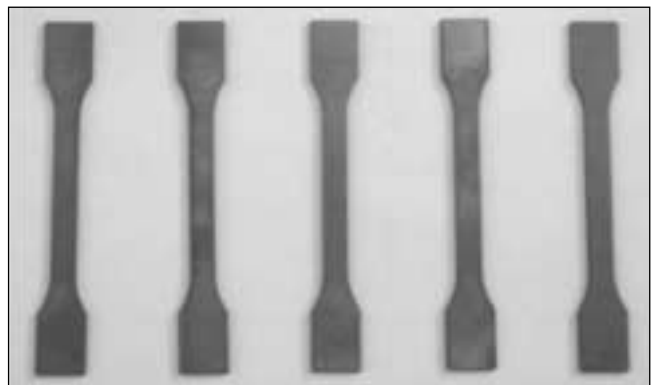
Fig. 10 – Alcuni dei provini usati nelle caratterizzazioni meccaniche.
