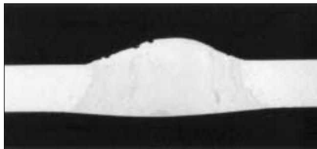
Fig. 1 – Lega di alluminio 5056 saldata TIG: porosità superficiale.
