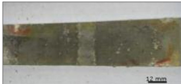
FIG. 9 Un giunto dopo la prova di SCC. A joint after the SCC test.
