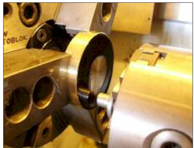
FIG. 2 Dettaglio della prova di usura a pin piano.
