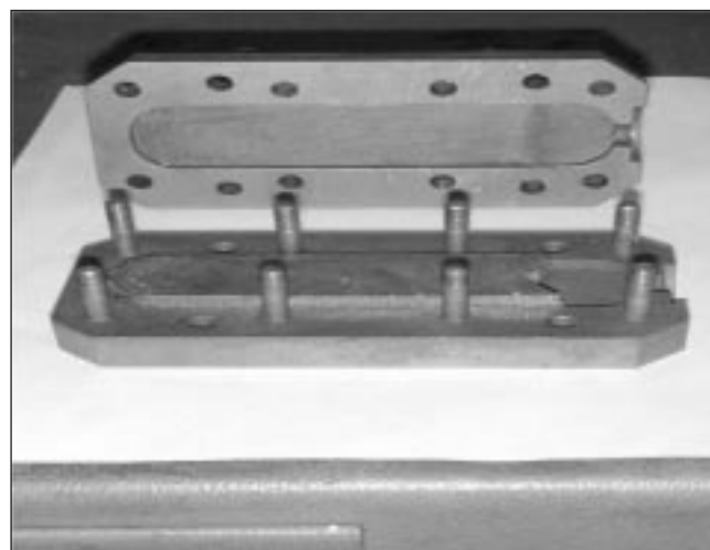
Fig. 1– Esempio di lingottiera e lingotto usati per preparare le leghe per lo studio.
