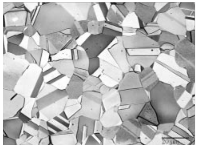
Fig. 4 – M.O. dopo attacco con la soluzione alcolica di FeCl 3 e HCl, sezione longitudinale della lega F allo stato ricotto (spessore 1mm).
