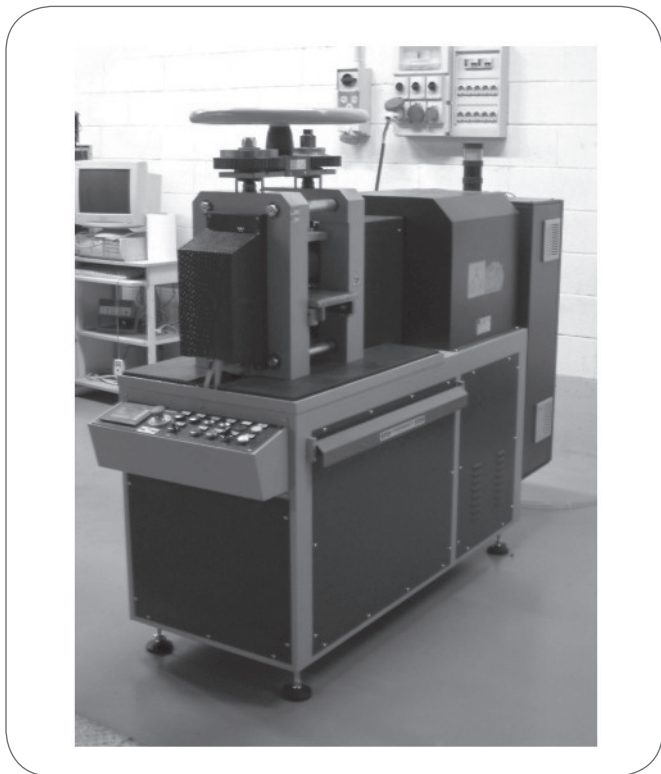
▲ Fig. 1 Vista del laminatoio asimmetrico utilizzato per le prove. View of the rolling mill used for the investigation.
