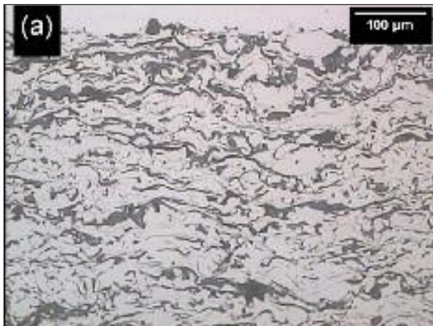
FIG. 2 (a) Micrografie di rivestimenti ottenuti con tecnica APS a base CoNiCrAlY con: a) polveri di allumina grossa (serie 1), b) polveri di allumina a grana fine (serie 2), c) polveri di allumina a grana grossa sferoidale (serie 3).
