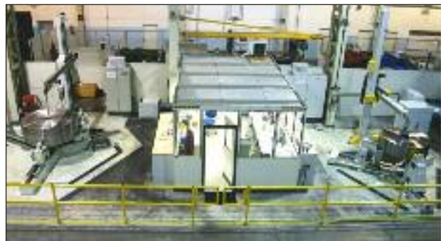
FIG. 8 General view of the 2 automated US inspection equipments. Vista generale della stazione automatica 2 per l'ispezione a ultrasuoni.
