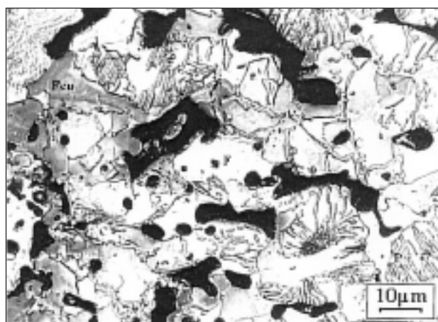
FIG. 4 (MO, 1000x) Acciaio 0.5% C, 2,5% Cu, bal. Fe sinterizzato a 1120°C per 30' in atmosfera di endogas. Micrografia ottica: ferrite (F), ferrite ricca in rame (Fcu), perlite (P), cementite ai bordi dei grani (C).
