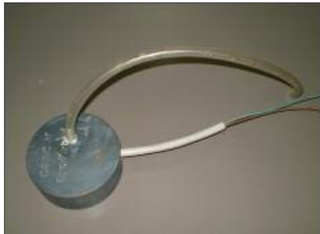
FIG. 5 Tubicino per la misura di potenziale.
