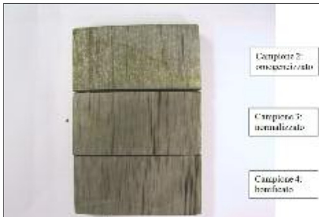
FIG. 6 Schema dei sezionamenti effettuati sul campione 1 dopo solubilizzazione per ricavare i campioni 3 e 4 da sottoporre rispettivamente a normalizzazione - 900^{\circ}\text{C} \times 30 \text{ min} e bonifica ( 900^{\circ}\text{C} \times 1 \text{ h} + \text{raffreddamento in acqua} + 600^{\circ}\text{C} \times 60 \text{ min} ).
