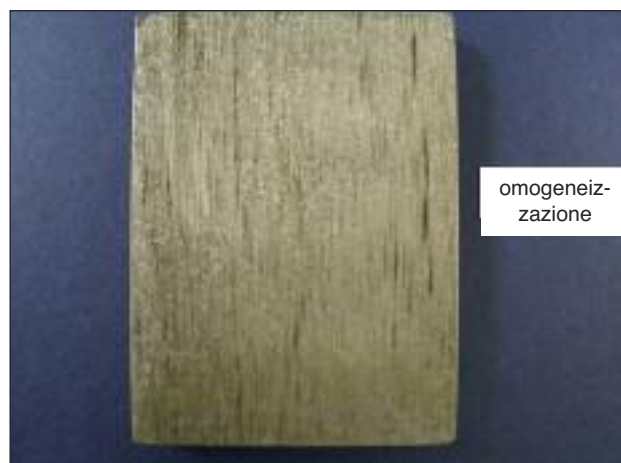
FIG. 5 Campione 1 - analisi macrografica dopo omogeneizzazione (1320 °C per 80 min + raffreddamento in aria).
