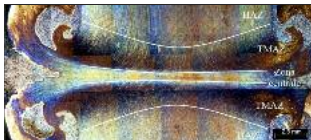
FIG. 4 Micrografia a basso ingrandimento del cordone di saldatura.
