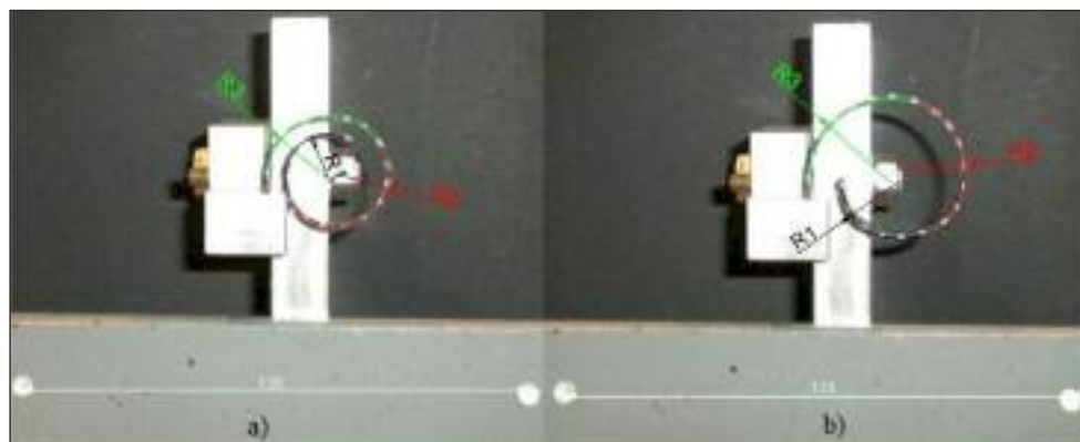
FIG. 5 Effetto memoria di forma a due vie sulla lamina L2: a) forma recuperata "a caldo" e b) forma recuperata "a freddo".
