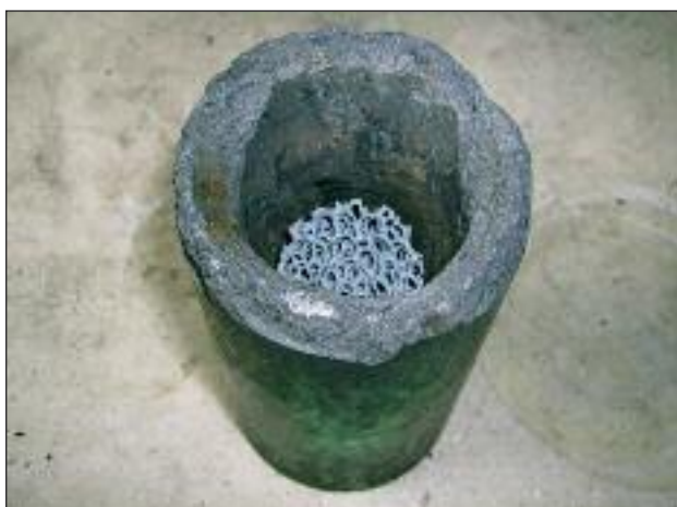
FIG. 3 Alloggiamento del filtro ceramico nella lingottiera di grafite. Ceramic filter placement into graphite ingot mold.
