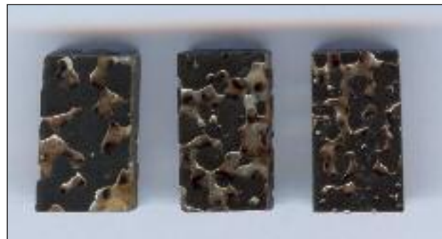
FIG. 5 Provini in schiuma d'acciaio per prove di porosità compressione monoassiale a tre differenti porosità.
