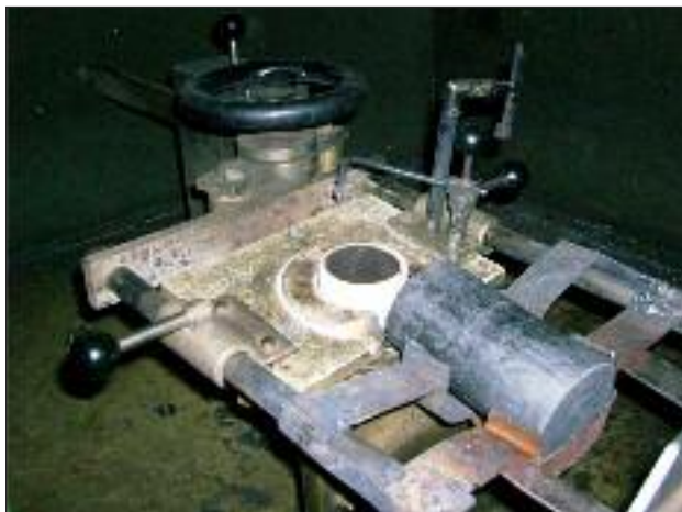
FIG. 2 Particolare del crogiolo e della lingottiera. Crucible and ingot mold details.
