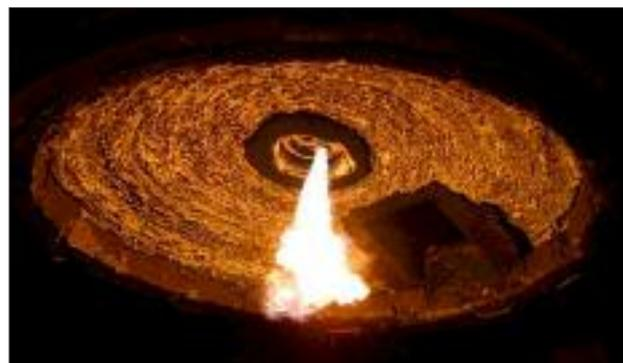
**FIG. 2** Bruciatore O<sub>2</sub>-CH<sub>4</sub> da 2500 kW per riscaldamento siviera. 2500 kW O<sub>2</sub>-CH<sub>4</sub> burner for steel ladle preheating.
