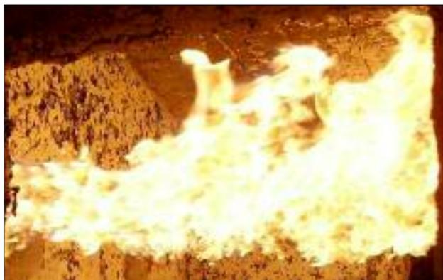
**FIG. 6** *Esempio di fiamma Ossigeno-Metano da bruciatore flameless.*
