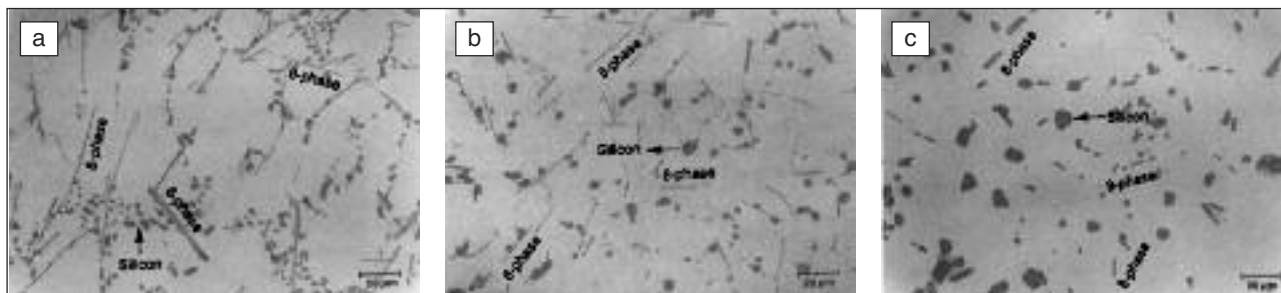
FIG. 21 Micrografie di una lega A319 senza Mn e contenente l'1% di Fe sottoposta a trattamento termico di solubilizzazione per 8 h a una temperatura di (a) 485, (b) 515 e (c) 535 °C [45].
